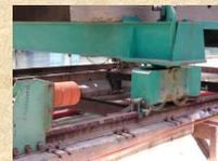
Per evitare il troppo funzionamento del fine corsa e degli arresti respingenti è necessario tenere, appena possibile, la via di corsa sufficientemente più lunga della corsa strettamente necessaria, per le traiettorie da far compiere ai carichi.
